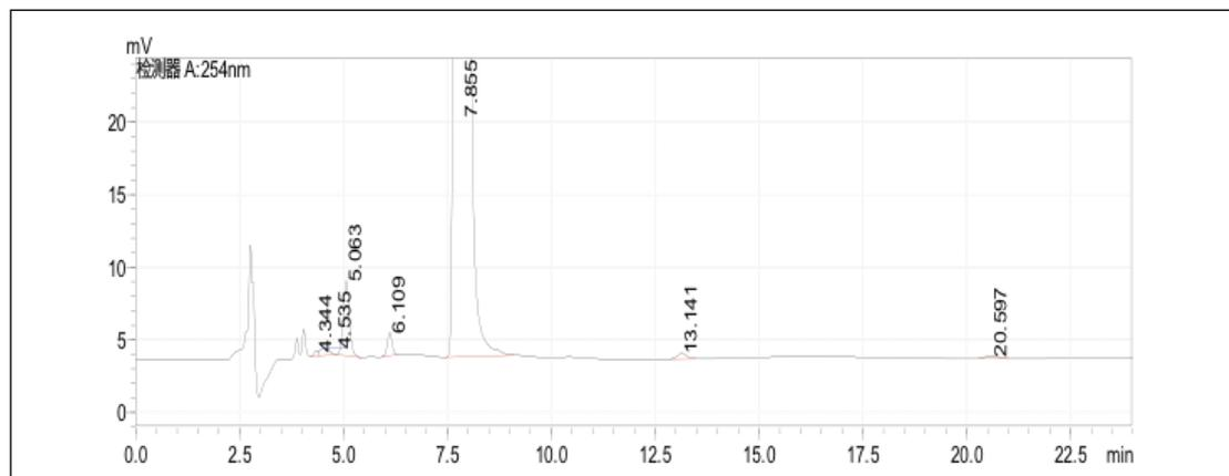
图7. 应用药典方法（等度）和5 μm粒径的HPLC色谱柱得到的头孢唑肟钠样品溶液（编号522）紫外色谱图。
