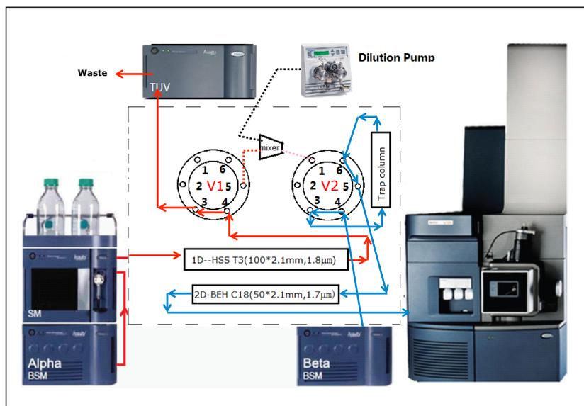
图4. Step3.将捕集柱上样品反冲至二维色谱柱上进行分离后进入质谱系统。
